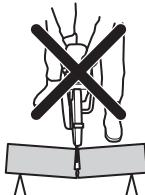
Ako je disk prikliješten ili zaustavljen u području povratnog trzaja, reakciona sila će gurati motorni rezac prema gore i nazad prema korisniku u rotirajućem pokretu, uzrokujući ozbiljne ili smrtonosne povrede. Pazite na potencijalno pomjeranja komada s kojim se radi. Ako komad s kojim se radi nije pravilno oslonjen i pomjera se prilikom rezanja, moguće je da će prikliješti nož i izazvati povratni trzaj.
