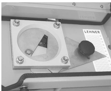
Sur la position 0, le volet doseur est presque complètement fermé ; il est ouvert au maximum sur la position 20. L'ouverture du volet doseur peut être réglée en continu dans cette plage.
