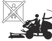
Μην χρησιμοποιείτε τη ζώνη ασφαλείας εάν το σύστημα ROPS είναι αποσυμπλεγμένο.
