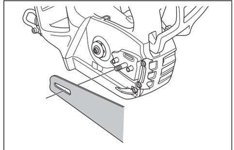
4. Portare la barra di guida nella sua posizione più arretrata. Sollevare la catena sopra il pignone guida e inserirla nella scanalatura sulla barra di guida. Cominciare dalla parte superiore della barra di guida.
