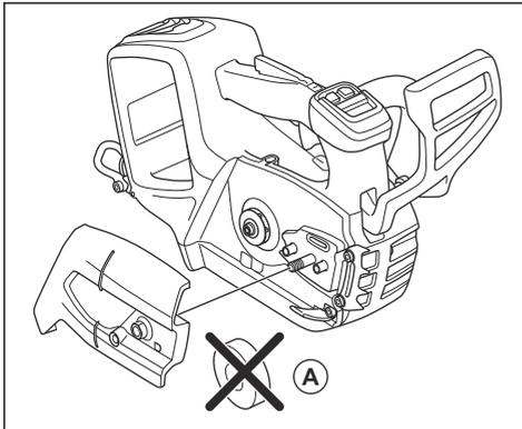
3. Montare la barra di guida sul bullone della barra.
