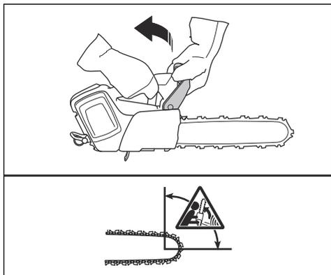
Il modo in cui il freno della catena viene innestato è correlato alla forza del contraccolpo e alla posizione del prodotto. In caso di intenso contraccolpo mentre il relativo settore è quello più lontano dall'operatore, il freno della catena viene innestato dal meccanismo inerziale. Se il contraccolpo è leggero e il settore di contraccolpo è più vicino all'operatore, il freno della catena viene innestato manualmente con la mano sinistra.
