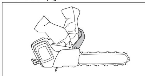
3. Accelerare al massimo e inclinare il polso sinistro in avanti per innestare il freno della catena.
