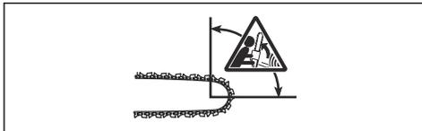
Il contraccolpo avviene sempre lungo il piano di taglio della barra guida. In genere, il prodotto viene lanciato contro l'operatore, ma può anche spostarsi in un'altra direzione. Il modo in cui si utilizza il prodotto, quando
