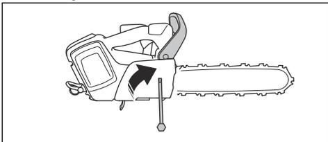
4. Serrare il dado della barra con la chiave e sollevare contemporaneamente la parte anteriore della barra di guida.
