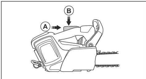
3. Assicurarsi che la leva di comando sia bloccata sul minimo quando viene rilasciato il fermo della leva di comando.
