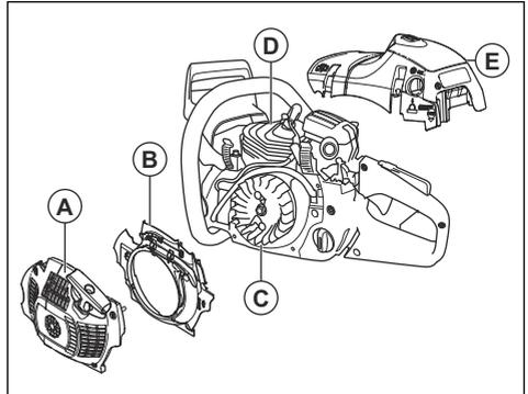
1. Reinigen Sie das Kühlsystem wöchentlich oder bei Bedarf häufiger mit einer Bürste.
