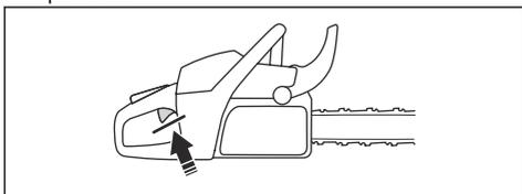
4. Zaženite izdelek in pritisnite polni plin.
