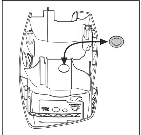
2. Wenn die Temperatur -5 °C oder weniger beträgt, montieren Sie die Winterabdeckung auf dem Startvorrichtungsgehäuse.
