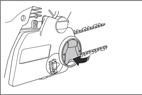
6. Stellen Sie sicher, dass sich die Sägekette leicht von Hand drehen lässt und nicht an der Führungsschiene herabhängt.
