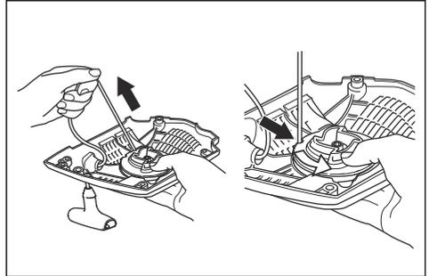
5. Entfernen Sie die mittlere Schraube und die Riemenscheibe.
