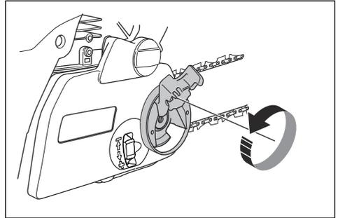
3. Drehen Sie die Kettenspannrolle nach unten (+), um die Spannung an der Sägekette zu erhöhen. Drehen Sie die Kettenspannrolle nach oben (-), um die Spannung an der Sägekette zu verringern.
