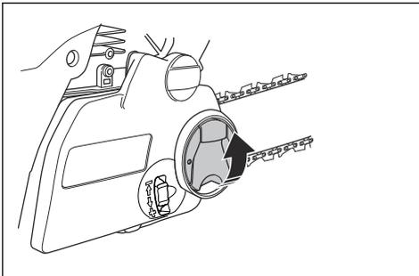
2. Lösen Sie den Kupplungsdeckel, indem Sie den Knauf gegen den Uhrzeigersinn drehen.
