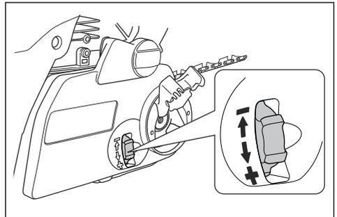
4. Ziehen Sie den Kupplungsdeckel fest, indem Sie den Knauf im Uhrzeigersinn drehen.
