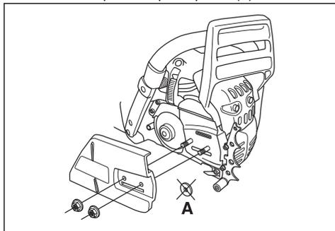
**Napomena:** Ako se poklopac kvačila teško skida, pritegnite navrtku vodilice, pa aktivirajte i pustite kočnicu lanca. Pri pravilnom otpuštanju se čuje klik.
