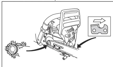
6. Poravnajte otvor na vodilici sa iglicom za podešavanje vodilice i postavite poklopac kvačila.
