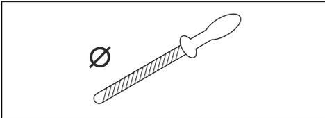
Lanac testere se teško pravilno oštiri ako nemate odgovarajuću opremu. Koristite Husqvarna turpiju za oštrenje. Ovako obezbeđujete maksimalne radne karakteristike pri rezanju i smanjujete opasnost od povratnog udara na minimum.
