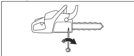
5. Pritežite navrtke vodilice ključem i istovremeno podignite vrh vodilice.
