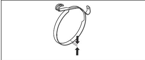
2. Proverite traku kočnice. Traka kočnice mora da bude debela bar 0,6 mm / 0,024 inča na najtanjem mestu.
