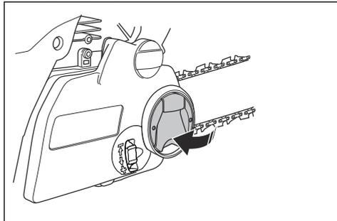
6. Uverite se da možete lako vučete lanac oko vodilice rukom i da ne visi sa vodilice.
