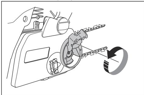
3. Okrenite točak zatezanja lanca prema dole (+) da biste povećali zatezanje lanca testere. Okrenite točak zatezanja lanca prema gore (-) da biste smanjili zatezanje lanca testere.
