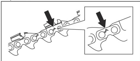
2. Uverite se da se lanac lako savija. Zamenite lanac ako je krut.
