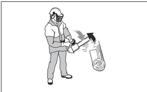
Používejte brzdu řetězu jako parkovací brzdu, když spouštíte výrobek a když se pohybujete na krátké
