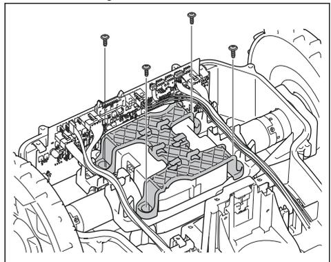
9. Trennen Sie den Akkuanschluss von der Hauptleiterplatte.
