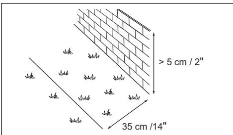
**Hinweis:** Wenn das Steinpflaster mindestens 30 cm / 12 Zoll breit ist, verwenden Sie die Werkseinstellung der Funktion *Über Schleife fahren* zum Mähen des Rasens neben dem Steinpflaster. Siehe *Einstellen der Funktion „Über Schleife fahren“ auf Seite 30*.
