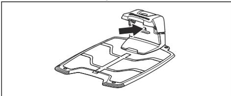
2. Wenn die LED-Anzeigeleuchte nicht grün leuchtet, führen Sie eine Überprüfung der Installation durch. Siehe *Installieren der Ladestation auf Seite 19* und *Anzeigelampe an der Ladestation auf Seite 47*.
