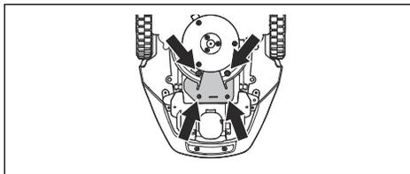
6. Rimuovere la vite della staffa di fissaggio della batteria e rimuovere la staffa.
