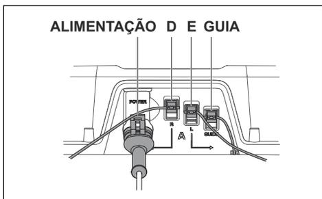
3. Alterne as ligações entre o cabo de guia e o cabo delimitador na estação de carregamento.
