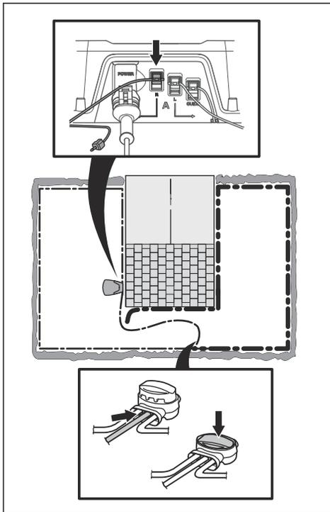
Se a luz indicadora ficar amarela intermitente, a rutura situa-se no fio entre a extremidade desligada e o ponto onde o novo fio é ligado (linha preta larga abaixo). Nesse caso, mova a ligação para o novo fio para mais perto da extremidade desligada (aproximadamente a meio da secção de fio onde possivelmente está a rutura) e verifique novamente se a luz indicadora fica verde.
