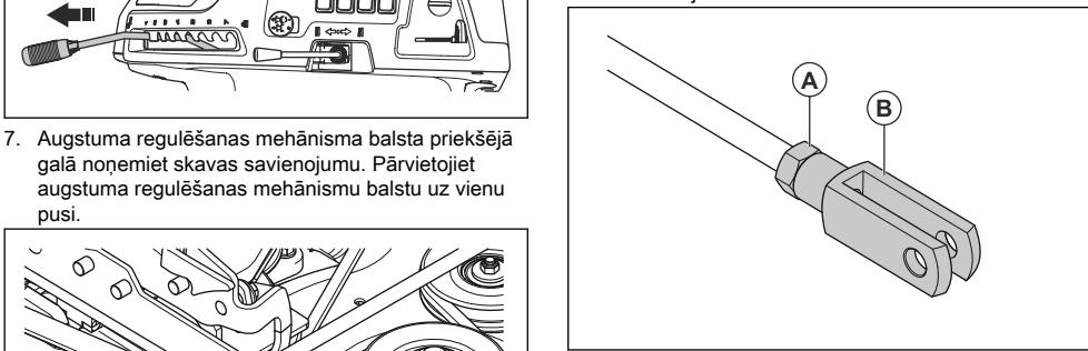
**Piezīme:** Abos augstuma regulēšanas mehānisma galos ir skavas savienojums. To pašu rezultātu var panākt neatkarīgi no tā, kuru skavas savienojumu regulējat.
