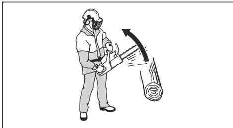
Manji poluprečnik vrha vodilice smanjuje silinu povratnog udara.
