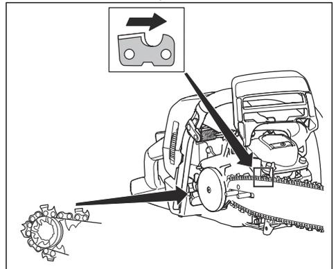
6. Poravnajte otvor na vodilici sa iglicom za podešavanje vodilice i postavite poklopac kvačila.
