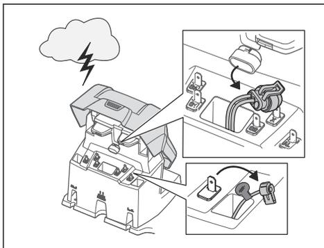
Para reduzir o risco de danificar os componentes elétricos do produto e da estação de carregamento, recomenda-se que desligue todas as ligações à estação de carregamento (fonte de alimentação, cabo delimitador e cabo de guia), caso exista o risco de trovoadas.
