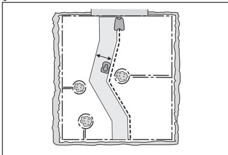
A largura do corredor é ajustada automaticamente. Se for necessário ajustar manualmente a largura do corredor para que o produto funcione de forma satisfatória, pode definir a largura do corredor entre 0-9. Se a largura do corredor de guia for definida para 0, o produto passa por cima do cabo de guia. A definição de fábrica é 6 para o cabo delimitador e 9 para o fio de guia.
