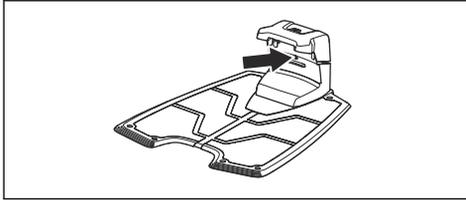
2. Certifique-se de que as ligações do cabo delimitador à estação de carregamento foram efetuadas corretamente e não estão danificadas. Certifique-se de que a luz indicadora na estação de carregamento continua azul intermitente.
