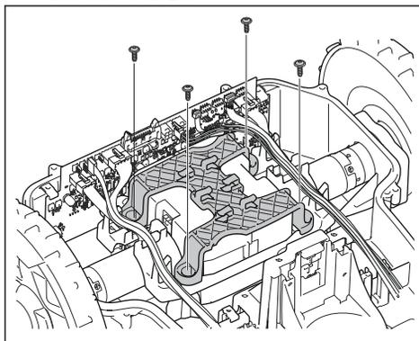
9. Desligue o conector da bateria da placa de circuito impresso principal.
