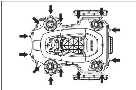
5. Levante a extremidade traseira da secção superior do chassis.
