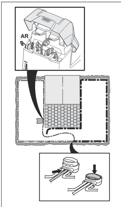
Se a luz indicadora ficar verde agora, a rutura situa-se no fio entre a extremidade desligada e o ponto onde o novo fio é ligado (linha preta larga abaixo). Nesse caso, mova a ligação para o novo fio para mais perto da extremidade desligada (aproximadamente a meio da secção de fio onde possivelmente está a rutura) e verifique novamente se a luz indicadora fica verde.
