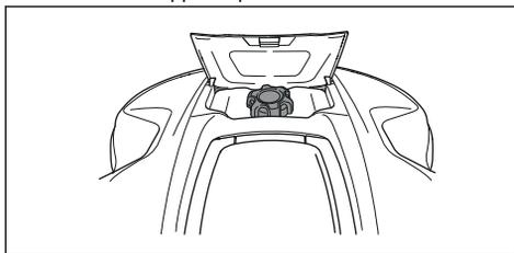
3. Tournez le bouton de réglage de la hauteur de coupe sur le produit pour sélectionner une hauteur de coupe.
