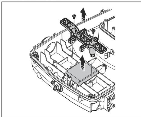
9. Débranchez le câble de batterie du panneau de commande du circuit principal.
