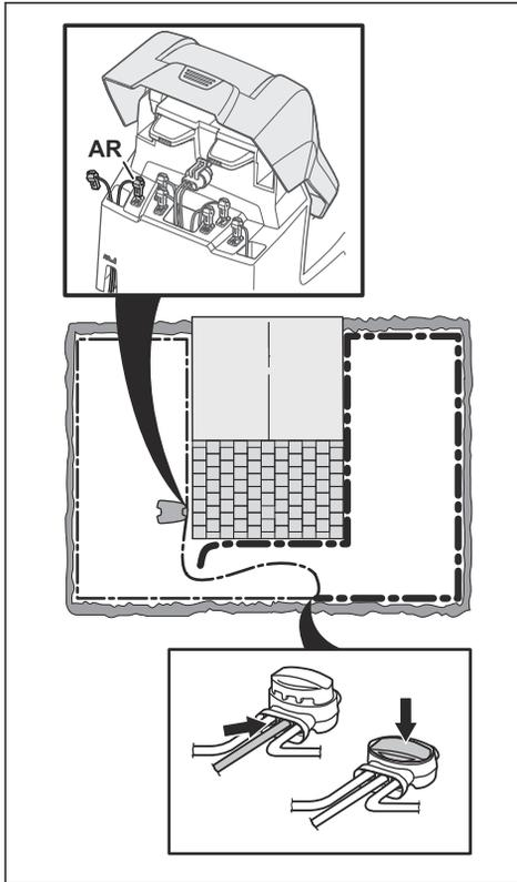
Si la luz indicadora ahora es verde, la rotura está en algún lugar del cable entre el extremo desconectado y el punto donde se conecta el cable nuevo (la siguiente línea negra y gruesa). En ese caso, acerque la conexión del cable nuevo a la punta desconectada (más o menos, en la mitad de la sección del cable que podría estar dañada) y vuelva a comprobar si la luz indicadora está en verde.
