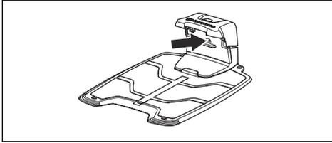
2. Compruebe que las conexiones del cable delimitador a la estación de carga están conectadas correctamente y no están dañadas. Compruebe que la luz indicadora de la estación de carga sigue parpadeando en azul.
