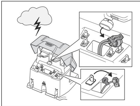
Per ridurre il rischio di danni ai componenti elettrici del prodotto e della stazione di ricarica, si consiglia di scollegare tutte le connessioni alla stazione di ricarica (alimentazione, cavo perimetrale e cavi guida) in caso di rischio di temporali.
