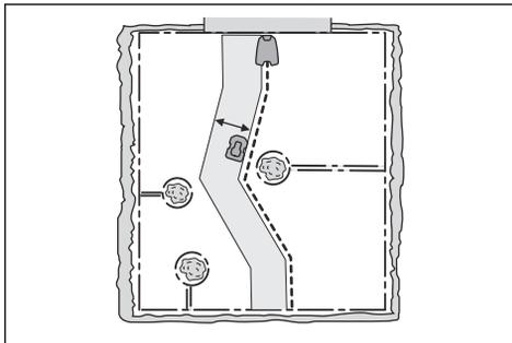
A largura do corredor é ajustada automaticamente. Apenas em raras ocasiões é necessário introduzir definições manuais. É possível definir a largura do corredor entre 0-9. Se a largura do corredor do guia for definida para 0, o produto passa por cima do fio de guia. A definição de fábrica é 6 para o cabo delimitador e 9 para o fio de guia.
