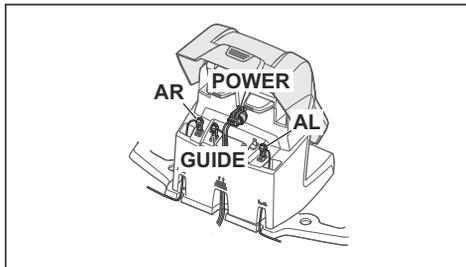
3. Alterne as ligações entre o cabo de guia e o cabo delimitador na estação de carregamento.
