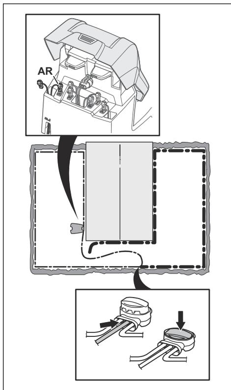
Se a luz indicadora ficar verde agora, a rutura situa-se no fio entre a extremidade desligada e o ponto onde o novo fio é ligado (linha preta larga abaixo). Nesse caso, mova a ligação para o novo fio para mais perto da extremidade desligada (aproximadamente a meio da secção de fio onde possivelmente está a rutura) e
