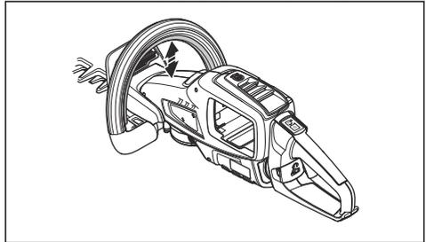
3. Pritisnite okidač paljenja za primjenu pune snage.
