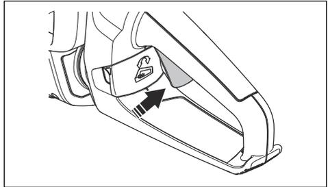
4. Otpustite okidač paljenja i provjerite ispravnost povratne opruge. Nož se mora zaustaviti za manje od jedne sekunde.
