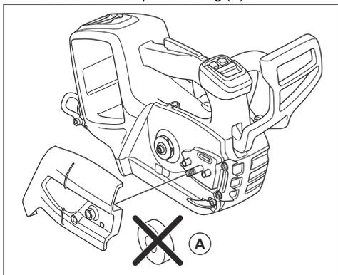
3. Install the guide bar on the bar bolt.
