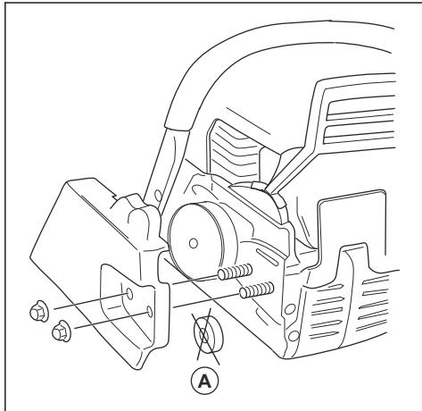
6. Совместите отверстие в направляющей шине со штифтом натяжителя цепи и установите кожух сцепления.
