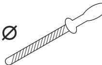
Без подходящего инструмента заточить цепь пилы очень сложно. Используйте шаблон для затачивания Husqvarna. Это поможет обеспечить максимальную эффективность резки и минимальный риск отдачи.
