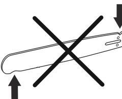
6. Убедитесь, что ведомая звездочка шины свободно вращается, а смазочное отверстие в ведомой звездочке не забито. При необходимости следует провести очистку и смазку.
