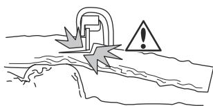
1. Выполните пропил движением от себя (с нажимом) на глубину примерно  $\frac{1}{3}$  диаметра бревна.
