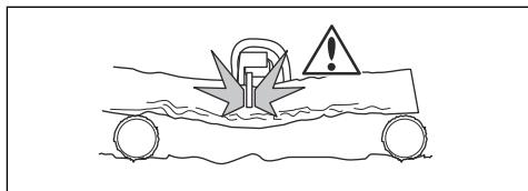
1. Выполните пропил движением на себя (с протягом) на глубину примерно  $\frac{1}{3}$  диаметра бревна.
