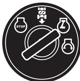
(RU) После запуска двигателя оставьте ключ зажигания в положении “ON”. Установите регулятор газа на нужную скорость. Для кашения: полный газ
