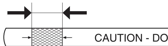
**CZ** Hladina by se měla nacházet mezi dvěma značkami na měrce. V případě potřeby doplňte olej tak, aby hladina dosáhla na horní okraj mřížkované značky na měrce. Pro přibližný objem a typ oleje viz část „SPECIFIKACE PRODUKTU“ této příručky. Nepřeplňujte.
