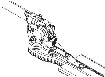
**OBS!** Växeln ska ej fyllas helt med fett. Fettet expanderar av den värme som uppstår när maskinen körs. Skulle växeln vara helt fyld med fett finns det risk för förstörda tätningsar och fettläckage.
