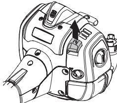
Paina koneen runkoa maata vasten vasemmalla kädellä (HUOM! Ei jalallat!). Tartu käynnistyskahvasta, vedä käynnistysnarusta hitaasti oikealla kädellä, kunnes tunnet vastuksen (kytkentäkynnet tarttuват) ja vedä sen jälkeen painoa ja voimakkain vedoin. **Älä koskaan kiedo käynnistysnarua käsies ympärille.**
