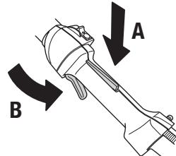
Kontrollera att gasreglaget är låst i tomtgångsläge när gasreglagespärren är i sitt ursprungsläge.
