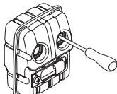
Jos koneesi äänenvaimennin on varustettu kipinänksammutusverkolla, on myös se puhdistettava säännöllisesti. Tukkeutunut verkkohihna aiheuttaa moottorin kuumentumisen, mistä seuraa vakava moottorivaurio.
