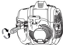
Knivene skal heller ikke bevege seg med chokeregulatoren i startgasstilling.
