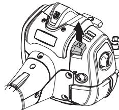
Irrota ilmansuodattimen koteloa ja poista suodatin. Pese se puhtaaksi lämpimällä saippuavedellä. Varmista, että suodatin on kuiva ennen takaisin asentamista.
