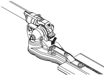
**HUOM!** Vaihdetta ei saa täyttää aivan täyteen rasvalla. Rasva laajenee koneen käytön aikana kehittyvän lämmön vaikutuksesta. Jos vaihde on aivan täynnä rasvaa, on olemassa tiivisteiden vaarioitumisen ja rasvavuodon vaara.
