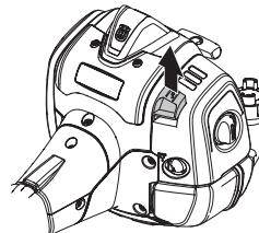
Demonter luftfilterdekselet og ta ut filteret. Vask det rent i varmt såpevann. Se etter at filteret er tørt før det monteres igjen.
