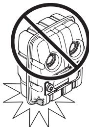
Tarkasta säännöllisesti, että äänenvaimennin on kunnolla kiinni koneessa.
