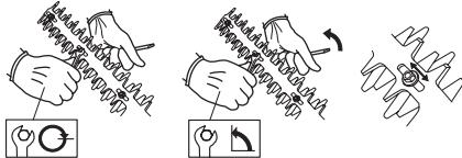
Vid korrekt justerade knivar skall det, mätt vid skruvarna, vara ett spel mellan knivarna på 0,2-0,4 mm.
