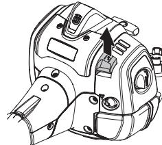
Afmonter luftfilterdækslet, og fjern filteret. Vask det i varmt sæbevand. Sørg for, at filtret er helt tørt, når det genmonteres.
