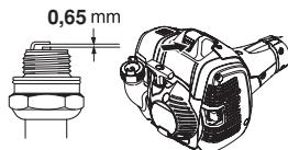
**OBS!** Använd alltid rekommenderad tändstiftstyp! Felaktigt tändstift kan förstöra kolv/cylinder. Se till att tändstiftet har s.k. radioavstörning.
