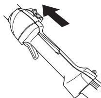
**HUOM!** Pysäytyskosketin palautuu automaattisesti käynnistysasentoon. Sen vuoksi, tahattoman käynnistyksen estämiseksi, sytytystulpan suojuus on aina irrotettava sytytystulpan asennuksen, tarkastuksen ja/ tai huollon ajaksi.
