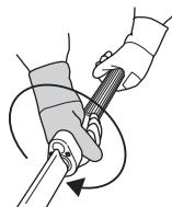
**OBS!** När stoppläget passerats är knivarna blockerade, försök inte att klippa med klippaggregatet i detta läge.
