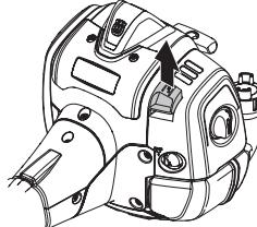
Trykk maskinkroppen mot bakken med venstre hånd (OBS! Ikke med føten!). Ta tak i starthåndtaket med høyre hånd og dra langsomt ut startsnoren til du merker motstand (starthakene griper inn) og trekk deretter raskt og kraftig til. **Surr aldri startlinien rundt hånden.**
