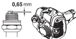
**OBS!** Bruk alltid anbefalt type tennplugg! Feil tennplugg kan ødelegge stempel/sylinder. Påse at tennpluggen har såkalt radiostøtfILTER.
