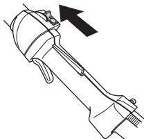
**BEMÆRK!** Stopkontakten skifter automatisk til startposition. For at undgå utilsigtet start skal tændhætten derfor altid tages af tændrøret ved montering, kontrol og/eller vedligeholdelse.
