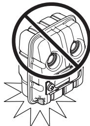
Kontrollér regelmæssigt, at lyddæmperen sidder fast i maskinen.
