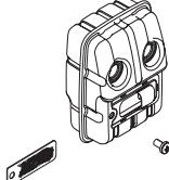
**VARNING!** Katalysatorljuddämparen blir mycket het såväl vid användning som efter stopp. Detta gäller även vid tomgångskörning. Beröring kan orsaka brännskador på huden. Var uppmärksam på brandfaran!
