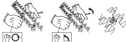
Ved korrekt justerede knive skal der, målt ved skruerne, være et spil mellem kniven på 0,2-0,4 mm.
