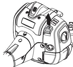
Demontera luftfilterkåpan och tag bort filtret. Tvätta det i varmt tvålsvatten. Se till att filtret är torrt då det åter monteras.
