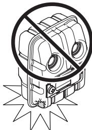
Kontroller regelmessig at lyddemperen sitter fast i maskinen.
