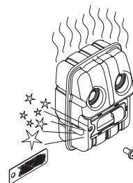
På ljuddämpare utan katalysator bör nätet rengöras och eventuellt bytas en gång per vecka. På katalysatorljuddämpare skall nätet kontrolleras och eventuellt rengöras en gång per månad. **Vid ev. skador på nätet skall detta bytas.** Om nätet ofta är igensatt, kan detta vara ett tecken på att katalysatorns funktion är nedsatt. Kontakta din återförsäljare för kontroll. Med ett igensatt nät överhettas maskinen med skador på cylinder och kolv som följd.
