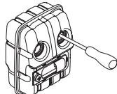
Er din maskines lyddæmper udstyret med et gnistfangernet, skal dette rengøres regelmæssigt. Et tilstoppet net medfører, at motoren kører varm med alvorlig motorskade til følge.
