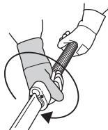
**OBS!** Når stoppstilling er passert, er knivene blokkert, ikke forsøk å klappe med klippeaggregatet i denne stillingen.
