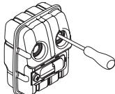
Hvis lyddemperen i maskinen er utstyrt med gnistfangernettet, må dette rengjøres regelmessig. Et tilstoppet nett fører til at motoren går varm med alvorlig motorskade som følge.
