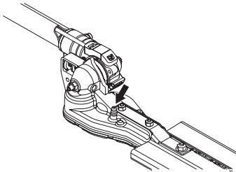
**BEMÆRK!** Gearet skal ikke fyldes helt med fedt. Fedtet udvides af den varme, som opstår, når maskinen kører. Hvis gearet var helt fyldt med fedt, er der risiko for ødelagte pakninger og fedtlækage.
