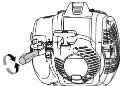
Knivarna skall ej heller röra sig med chokereglaget i startgasläge.
