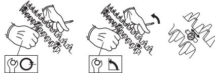
Ved korrekt justerte kniver skal det, målt ved skruene, være en klarering mellom knivene på 0,2-0,4 mm.
