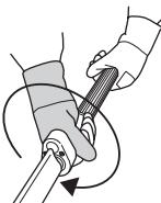
**NOTA!** Passado o ponto de paragem as facas ficam bloqueadas; não tente cortar com a unidade de corte nesta posição.
