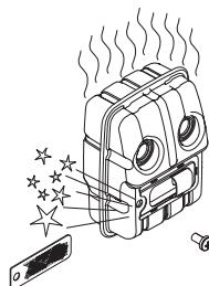
Мрежата на ауспуси без катализатор се почиства и при необходимост се подменя ежеседмично. Мрежата на ауспуси с катализатор се проверява и при необходимост се подменя веднъж на месец. В случай, че мрежата е повредена, тя трябва да се подмени. Честото задръстзване на мрежата може да е показател за повреда в катализатора. Обърнете се към дистрибутора си за технически преглед. Ако работите със задръстена мрежа, двигателят се пренагрява, следствие на което се повреждат цилиндърът и буталото.
