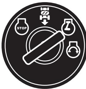
(CZ) Jakmile naskočí motor, uvolněte klíček, který se vrátí do polohy "ON" – zapnuto. Posuňte páčku plynu na požadovanou rychlosť. Pro sečení : nastavte plyn na plné otáčky.
