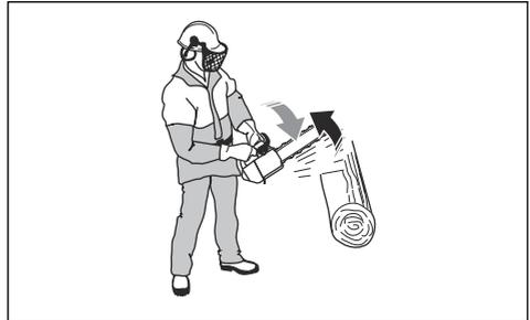
Verwenden Sie die Kettenbremse beim Starten des Geräts und bei kürzeren Transportstrecken als Handbremse. Dadurch reduzieren Sie das Risiko, dass Sie selbst oder Umstehende von der Sägekette erfasst werden.
