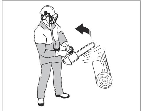
Je kleiner der Radius der Schienenspitze, desto geringer die Rückschlaggefahr.
