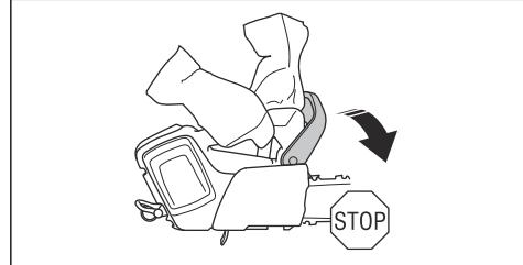
Způsob aktivace brzdy řetězu závisí na síle zpětného vrhu. Závisí také na poloze výrobku v době, když zóna zpětného vrhu narazí do předmětu. Pokud dojde k silnému zpětnému vrhu, když je zóna zpětného vrhu nejdále od vás, brzda řetězu se aktivuje setrvačností.
