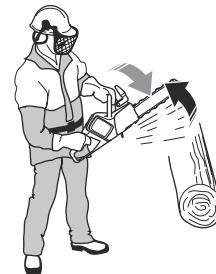
Seadme käivitamisel või lühiajalisel transportimisel teise töökohta kasutage ketipidurit nagu seisupidurit. See vähendab ohtu, et saekett riivab teid või mõnda lähedalasuvat inimest.
