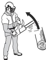
Manji poluprečnik vrha vodilice smanjuje silinu povratnog udara.
