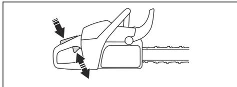
2. スロットルトリガーロックを押し下げて、放すと元の位置に戻ることを確認します。
