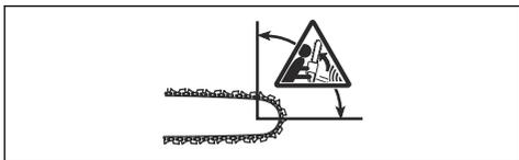
キックバックは、常にガイドバーの切削面で起こります。通常、本体は作業者に向かって跳ね返りますが、別の方向に向かう場合もあります。キックバック発生時に本製品をどのように使用していたかによって、キックバックの動きの方向が決まります。
