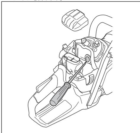
3. 5°C を下回る気温や降雪に対処するために、冬用カバーをご用意しています。スターターハウジングにこの冬用カバーを取り付けます。冬用カバーは、キャブレタースペースへの冷気の流入を低減し、雪が侵入するのを防ぎます。
