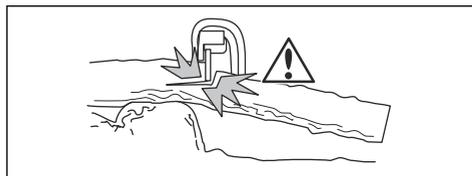
1. 幹を押し切りで約 1/3 切断します。
