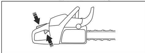
8. フロントハンドガードを後方に動かして、チェーンブレーキを解除します。
