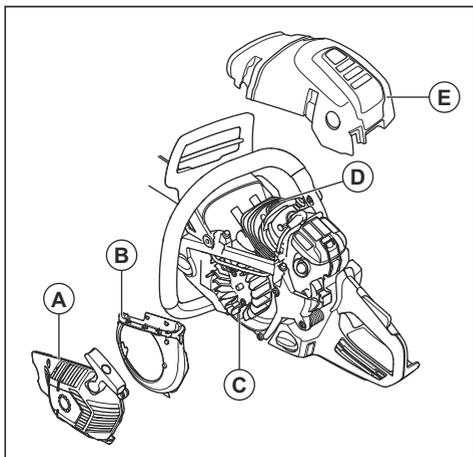
1. 必要に応じて、ブラシを使用して週に 1 回以上の頻度で冷却システムを清掃してください。
