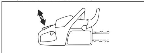
3. スロットルトリガーロックを放したとき、スロットルトリガーがアイドルリングの位置にロックされていることを確認します。
