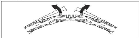
8. 張力が解放されてから、屈曲の反対側から木／枝を切断します。
