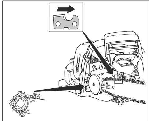
6. ガイドバーの穴をチェーン調整ピンに合わせて、クラッチカバーを取り付けます。
