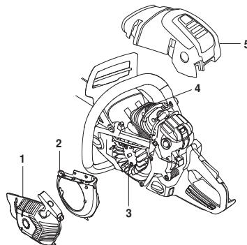
Rashladni uređaj čisti četkom jednom nedeljno, a po potrebi i češće. Prljav ili začepljen rashladni uređaj dovodi do pregravanja mašine i oštećenja klipa i cilindra.
