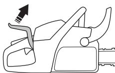
Testeru nikada nemojte nositi ili kažti o okidač! To bi moglo da ošteći mehanizam i onemogući korišćenje kočnice za lanac.
