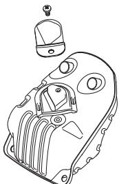
Prigušivač je zamišljen da smanji buku i usmeri izduvne gasove daleko od rukovaoca. Izduvni gasovi su vredni i u njima zna da bude varnica, što može da izazove požar ako su gasovi usmereni na svu i zapaljiv materijal.
