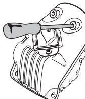
Neki prigušivači opremljeni su specijalnom mrežom. Ako tvoja mašina ima takav prigušivač treba mrežu čistiti bar jednom nedeljno, što se radi žičanom četkom. Blokirana mreža izazvaće pregrevanje mašine i može da dovede do ozbiljnih oštećenja.
