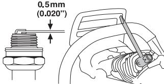
Beleška! Uvek upotrebjavaj preporučen tip svećice! Pogrešna svećica može da dovede do teškog oštećenja klipa/cilindra. Proveri da svećica ima tkz. zaštitu protiv radio valova.
