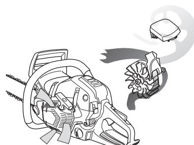
**VAŽNO!** Za trajno funkcionisanje centrifugalnog čišćenja potrebno su stalno održavanje i briga. Očistiti ulaz vazduha u starter, elise zamajca, prostor oko zamajca, ulaznu cev i karburatorski prostor.
