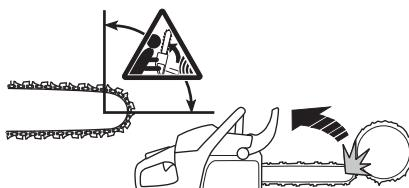
Lančana testera uvek odskače u ravni sečenja. Lančana testera i mač obično odskaču unatrag i nagore u pravcu rukovaoca. Ipak, lančana testera može da odskoci i u drugom smeru zavisno od načina na koji je upotrebljavana u trenutku kada je zona odskoka na maču dotakla predmet.
