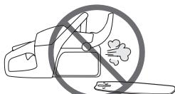
• Kočnica lanca treba biti uključena prilikom pokretanja pile. Pogledajte obavijesti u odjeljku Pokretanje i zaustavljanje. Nikada ne pokrećite motornu pilu dok je okrenuta nadolje. Ovaj način je iznimno opasan jer lako možete izgubiti nadzor nad pilom.
