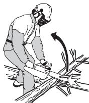
Morate imati nadzor nad predmetom rada. Kada su dijelovi koje namjeravate rezati mali i lagani, mogu se zaglaviti u i biti izbačeni prema vama. Čak i kada niste u opasnosti, možete se iznenaditi i izgubiti nadzor nad pilom. Uvijek razdvojite poredane trupce ili grane prije rezanja. Pilite isključivo pojedinačne trupce ili komade drva. Uklonite
