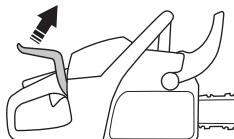
**¡La sierra no se debe llevar ni colgar nunca por/en la horquilla! De hacerlo, puede dañarse el mecanismo, con lo que deja de funcionar el freno de cadena.**
