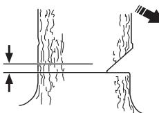
Coloque o apoio para casca (se estiver montado) atrás da linha de ruptura. Serre com aceleração total e deixe a corrente/lâmina penetrar devagar na árvore. Observe se a árvore se move no sentido contrário ao da direcção de queda pretendida. Introduza uma cunha de abate ou barra extractora logo que a profundidade de corte o permita.
