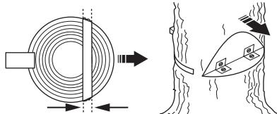
Se pierde completamente el control de la dirección de derribo del árbol si la faja de desgaje es demasiado
