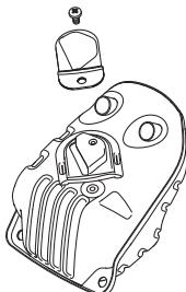
El silenciador está diseñado para amortiguar el ruido y para apartar del usuario los gases de escape. Los gases de escape están calientes y pueden contener chispas que pueden ocasionar incendios si se dirigen los gases a materiales secos e inflamables.
