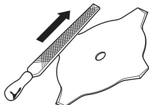
Ελέγχετε το εξάρτημα κοπής για ζημίες ή εμφάνιση ραγισμάτων. Το κατεστραμμένο εξάρτημα κοπής πρέπει πάντα να αντικαθίσταται.
