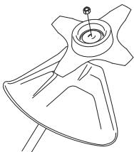
Κατά τη συναρμολόγηση, σφίξτε το παξιμάδι στρέφοντάς το αντίθετα προς τη φορά περιστροφής του εξαρτήματος κοπής. Χαλαρώστε το παξιμάδι για να το αφαιρέσετε, στρέφοντάς το κατά τη φορά περιστροφής του εξαρτήματος κοπής. (**ΠΡΟΣΟΧΗ!** το παξιμάδι έχει αριστερόστροφο σπείρωμα.) Ασφαλίστε τον ξόνα της λεπίδας με το κλειδί L.
