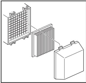
**ru** Чистка воздушного фильтра. Ослабьте винт, снимите крышку и снимите картридж фильтра. В случае засорения воздушного фильтра двигатель будет работать ненадлежащим образом и может выйти из строя. Заменяйте воздушный фильтр ежегодно или даже чаще, если вы работаете в условиях сильной запыленности. Обратитесь к руководству по эксплуатации двигателя. (Прочитайте также прилагаемое руководство по эксплуатации двигателя.)
