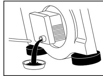
**ru** **ПРИМЕЧАНИЕ:** Перед тем как использовать триммер чтобы слить масло, дайте двигателю поработать до полного использования топлива в бензобаке.
