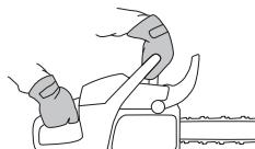
Daj puni gas i aktiviraj kočnicu lanca tako da okrećeš lijevi ručni zglob prema štitniku trzaja. Ne puštaj prednji rukohvat. **Lanac se odmah zaustavlja.**
