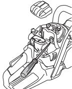
За температури под -5° и/или при снеговалеж е предвиден специален капак, който се монтира на корпуса на стартера.
