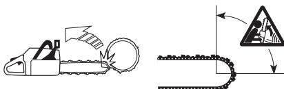
Lančana testera uvek odskače u ravni sečenja. Lančana testera i mač obično odskaču unatrag u nagore u pravcu rukovaoca. Ipak, lančana testera može da odskoči i u drugom
