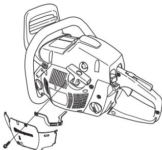
**ACHTUNG!** Ist ein spezieller Wintersatz montiert oder wurden temperatursteigernde Maßnahmen vorgenommen, so müssen diese Modifikationen vor der Anwendung bei normalen Temperaturen wieder rückgängig gemacht werden. Ansonsten besteht die Gefahr, dass das Gerät überhitzt wird, was schwere Motorschäden verursachen kann.
