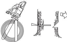
Der Fällschnitt soll parallel zur Kerbschnittlinie abschließen, so dass der Abstand zwischen beiden Schnitten mindestens  $\frac{1}{10}$  des Stammdurchmessers beträgt. Der nicht durchgesägte Teil des Stamm wird als Brechmaß bezeichnet.
