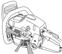
**WICHTIG!** Um die Funktion der Zentrifugalreinigung aufrecht zu erhalten, muss diese regelmäßig gewartet und gepflegt werden. Den Lufterlass der Startvorrichtung, die Gebläseflügel des Schwungrads,
