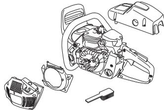
Das Kühlsystem einmal pro Woche mit einer Bürste reinigen, bei schwierigen Verhältnissen öfter. Eine Verschmutzung oder Verstopfung des Kühlsystems führt zur Überhitzung des Gerätes, die Schäden an Zylinder und Kolben zur Folge haben kann.
