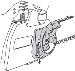
Die Kette ist korrekt gespannt, wenn sie von der Schienenunterseite nicht durchhängt, aber noch problemlos von Hand gedreht werden kann. Die Schienenspitze nach oben halten und die Schienenkupplung durch Drehen des Knaufs im Uhrzeigersinn anziehen.
