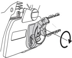
An einer neuen Kette muss die Kettenspannung oft kontrolliert werden, bis die Kette eingefahren ist. Die Kettenspannung regelmäßig prüfen. Mit einer richtig gespannten Kette wird eine gute Schnittleistung und eine lange Lebensdauer erzielt.
