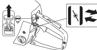
**Startgas:** Mit dem Kombinationshebel Choke/Startgas erhält man Startgas, wenn der Hebel wie oben beschrieben betätigt wird.
