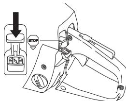
Motor ustavite z izklopnim stikalom.
