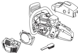
Hladilni sistem očistite s krtačo enkrat tedensko, v zahtevnih pogojih dela pa tudi pogosteje. Umazan ali zamašen hladilni
