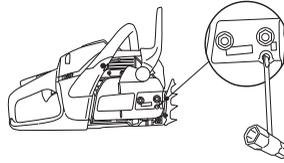
Die Kette ist richtig gespannt, wenn sie an der Schienenunterseite nicht durchhängt und noch leicht von Hand durchgezogen werden kann. Die Schienenspitze anheben und dabei gleichzeitig die Schienenmuttern mit dem Kombischlüssel festschrauben.
