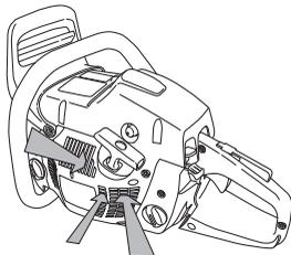
**POMEMBNO!** Učinkovitost centrifugalnega čiščenja je odvisna od rednega vzdrževanja in nege. Očistite dovod zraka v zaganjalnik, krila ventilatorja, prostor okrog ventilatorja, dovodno cev in komoro uplinjača.
