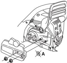
Die Schiene über die Schienenbolzen montieren. Die Schiene in der hintersten Position aufsetzen. Die Kette um das Kettenantriebsrad und in die Schienennut legen. Auf der Oberseite der Schiene beginnen.
