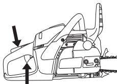
Pred dodajanjem polnega plina za nekaj sekund pustite stroj v prostem teku.
