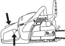
Die Maschine einige Sekunden im Leerlauf laufen lassen, bevor Vollgas gegeben wird.
