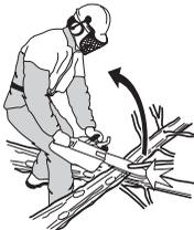
Nadzorujte delovni predmet. Če so delčki, ki jih želite rezati majhni in lahki se lahko zagodijo v verigo in jih vrže proti vam. Čeprav to ne pomeni nevarnosti se lahko presenetite in izgubite nadzor nad žago. Nikoli ne žagajte
