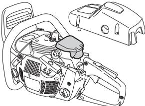
Eine gründlichere Reinigung erfolgt durch Auswaschen des Filters in Seifenwasser.
