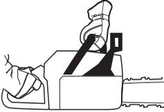
Poženite motor s polnim plinom in sprožite zavoro verige, tako da z levim zapestjem odsunete ščitnik odsunka. Pri tem ne spustite sprednjega ročaja. **Veriga se mora v trenutku ustaviti.**
