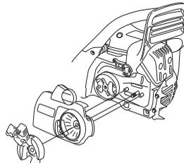
Die Schiene über die Schienenbolzen montieren. Die Schiene in der hintersten Position aufsetzen. Die Kette
