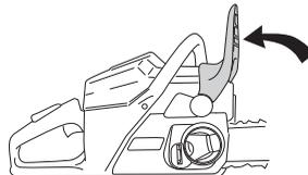
Knauf und Kupplungsdeckel (Kettenbremse) entfernen. Transportring abnehmen.
