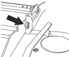
8. Установете лоста за повдигане на платформата за рязане в блокирано положение. Платформата за рязане се повдига.
