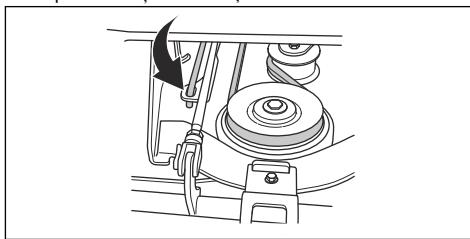
5. Amplasați cureaua de transmisie în jurul roșilor de transmisie. Cureaua de transmisie trebuie să fie pe partea corectă a roșii de întindere.
