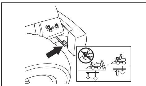
Рычаг системы привода для передней оси на модели Rider 320 AWD находится за левым передним колесом.
