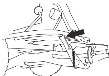
**AVERTISMENT:** Mecanismul de blocare vă poate răni degetele dacă nu îl manevrați cu atenție. Amplasați mecanismul de blocare al șasiului echipamentului în poziție verticală. Țineți marginea frontală a capului tăietor cu ambele mâini când continuați cu pasul următor.
