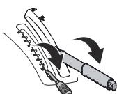
5. Apăsați în jos șasiul echipamentului. Ridicați mecanismul de blocare al șasiului echipamentului în poziție verticală.
