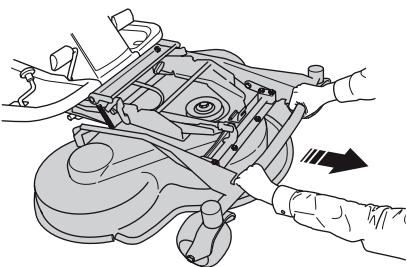
10. Apăsați în jos șasiul echipamentului. Ridicați mecanismul de blocare al șasiului echipamentului în poziție verticală.
