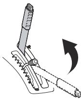
9. Натиснете платформата за рязане, докато задните насочващи елементи докоснат долната част на каналите на рамата на оборудването.
