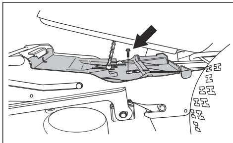
3. Разхлабете гайките на пръта за повдигане.
