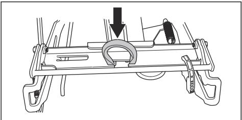
7. Задвиньте режущую деку в раму оборудования. Убедитесь, что передние направляющие входят в пазы на раме оборудования. Фиксатор рамы оборудования автоматически разблокируется.
