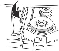
11. Amplasați cureaua de transmisie în jurul roșilor de transmisie. Cureaua de transmisie trebuie să fie pe partea corectă a roșii de întindere.
