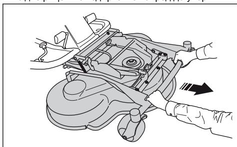
3. Повдигайте платформата за рязане във вертикално положение, докато се чуе щракане. Платформата за рязане се заключва автоматично във вертикално положение.
