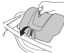
5. Потягніть ручку пружини від обойми пружини, щоб ослабити натяг приводного паса.
