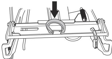
8. Поднимите опору регулировки высоты стрижки и установите ее в держатель.
