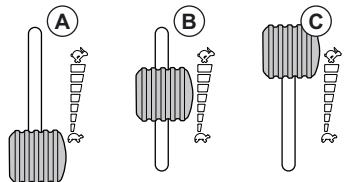
**Примечание:** Включение ножей, когда двигатель работает на полных оборотах, приводит к натяжению приводных ремней. Не открывайте дроссель полностью, пока режущая дека не будет опущена в рабочее положение.
