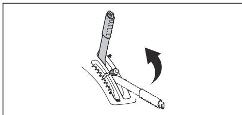
Для опускания режущей деки в рабочее положение нажмите кнопку блокировки и переместите рычаг подъема вперед. Если двигатель включен, ножи автоматически начнут вращаться.
