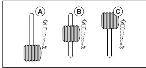
**Nota:** Cuplarea cujitelor când motorul funcționează la viteza maximă solicită excesiv curelele de transmisie. Nu aplicați accelerarea maximă înainte de a coborî capul tăietor în poziția de tuns iarba.
