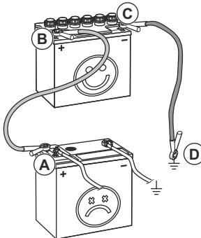
4. Conectați celălalt capăt al cablului roșu la borna POZITIVĂ (+) a bateriei complet încărcate (B).
