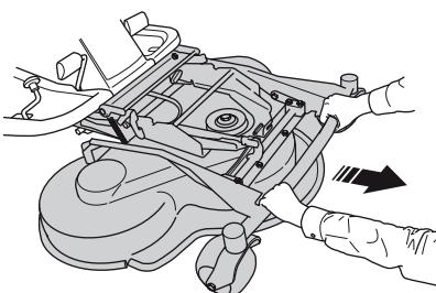
10. Надавите на раму оборудования вниз. Поднимите фиксатор рамы оборудования в вертикальное положение.
