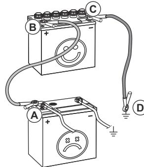
4. Подключите другой конец красного кабеля к ПОЛОЖИТЕЛЬНОЙ клемме (+) полностью заряженного аккумулятора (B).
