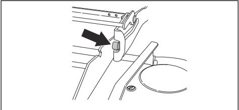
8. Установите рычаг подъема режущей деки в заблокированное положение. Режущая дека поднимется.
