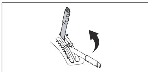
Pentru a coborî capul tăietor în poziția de tuns gazonul, apăsați butonul de blocare și deplasați pârghia de ridicare în față. Dacă motorul este pornit, rotația cuțitelor pornește automat.
