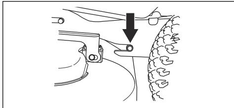
10. Установите опору регулировки высоты стрижки в соответствующее отверстие.
