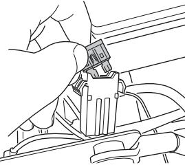
3. Замените перегоревший предохранитель предохранителем такого же типа, плоский штифт 15 A.
