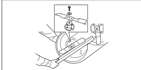
3. Ослабьте и снимите болт ножа, шайбы и нож.
