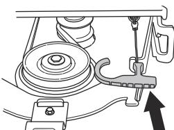
6. Зашептите крюк ручки пружины за край рамы оборудования.
