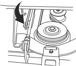
11. Протягніть приводний пас навколо привідних коліс. Переконайтесь, що приводний пас знаходиться з правильної сторони колеса натяжного шківа.
