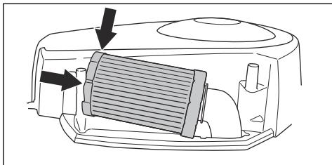
8. Установите крышку воздушного фильтра и затяните ручки.
