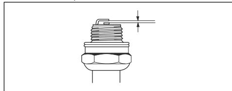
6. Согните боковой электрод для регулировки зазора между электродами.
