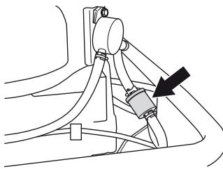
4. Вставьте новый топливный фильтр в концы шлангов. Нанесите жидкое мыло на края топливного фильтра, чтобы упростить соединение.
