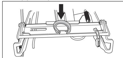
7. Натиснете платформата за рязане в рамата на оборудването. Уверете се, че предните насочващи елементи влизат в каналите на рамата на оборудването. Блокировката на рамата на оборудването се освобождава автоматично.
