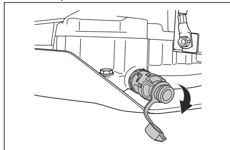
2. Для упрощения слива масла без проливов к концу сливной пробки можно подсоединить пластмассовый шланг.
