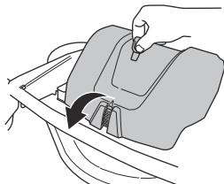
5. Вытяните ручку пружины из держателя пружины, чтобы ослабить натяжение приводного ремня.
