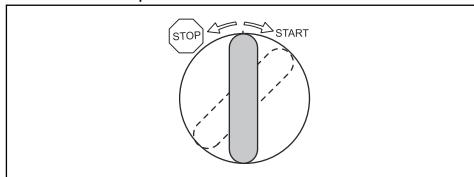
**Примечание:** Не включайте стартер более чем на 5 секунд за раз. Если двигатель не запускается, подождите 15 секунд перед повторной попыткой.
