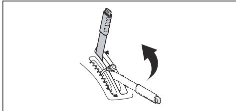
9. Задвигайте режущую деку до тех пор, пока задние направляющие не коснутся нижнего края пазов на раме оборудования.
