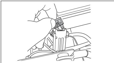
3. Замініть перегорілий запобіжник новим запобіжником такого ж типу, плаский штир 15 А.
