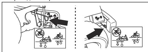
2. Поднимите режущую деку и включите стояночный тормоз.
