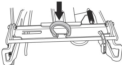
7. Împingeți capul tăietor în șasiul echipamentului. Asigurați-vă că opriotoarele de ghidare frontale intră în șasiul echipamentului. Mecanismul de blocare a șasiului echipamentului va fi eliberat automat.
