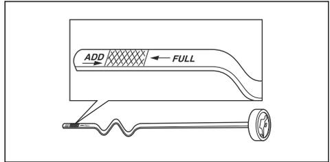
8. Оливу слід заливати крізь отвір, в якому встановлюється вимірювальний стрижень. Заливайте повільно. Не змішуйте різні типи оливи.
