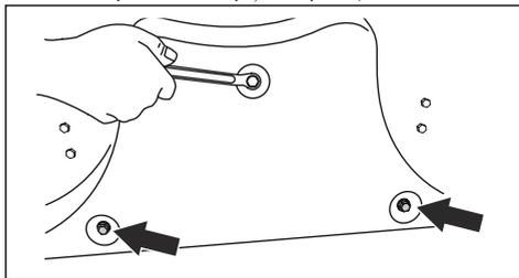
3. Introduceți 3 șuruburi M8x15 mm în orificiile șuruburilor pentru obturatorul colector pentru BioClip, pentru a împiedica deteriorarea filetelor.
