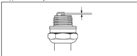
6. Согните боковой электрод для регулировки зазора между электродами.
