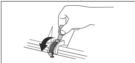
6. Поднимите опору регулировки высоты стрижки и установите ее в держатель.
