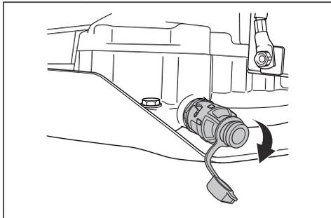
2. Для упрощения слива масла без проливов к концу сливной пробки можно подсоединить пластмассовый шланг.
