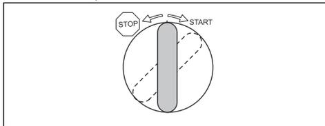
**Примечание:** Не включайте стартер более чем на 5 секунд за раз. Если двигатель не запускается, подождите 15 секунд перед повторной попыткой.
