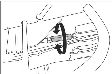
5. Після завершення регулювання затягніть гайки на підйомній розпірці.
