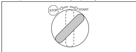
4. La pornirea motorului, eliberați imediat cheia de contact, permițându-i să revină în poziția neutră.
