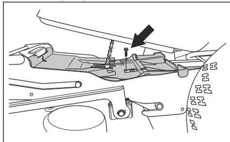
3. Ослабьте гайки на подъемной стойке.
