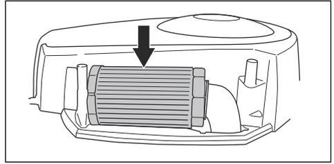
4. Очистьте паперовий фільтр, відбивши його об тверду поверхню. Не використовуйте стиснене повітря.
