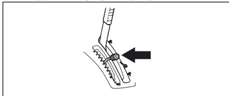
6. Нажмите кнопку блокировки на рычаге подъема режущей деки и опустите ее в рабочее положение.
