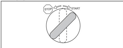
4. Після запуску двигуна негайно відпустіть ключ запалювання та поверніть його в нейтральне положення.
