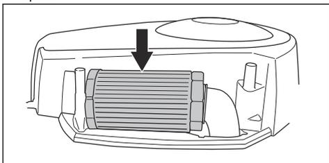
4. Постучите бумажным фильтром о твердую поверхность для его очистки. Не используйте сжатый воздух.
