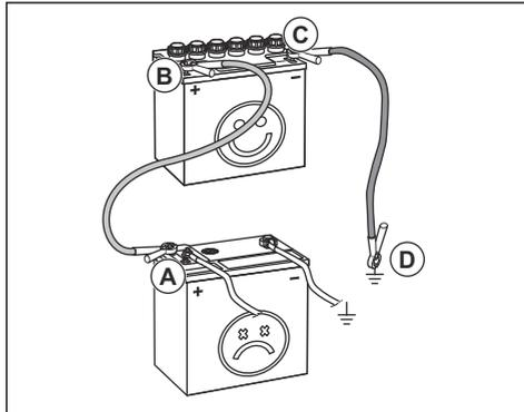
4. Подключите другой конец красного кабеля к ПОЛОЖИТЕЛЬНОЙ клемме (+) полностью заряженного аккумулятора (В).
