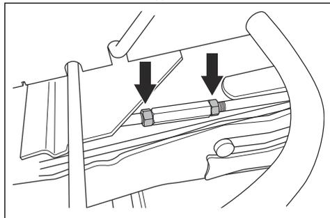
4. Поворачивайте подъемную стойку, чтобы удлинить опору или сделать ее короче. Удлините опору, чтобы поднять задний край кожуха. Укоротите опору, чтобы опустить задний край кожуха.
