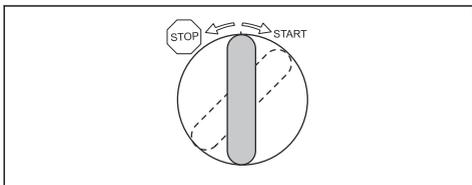
**Зверніть увагу:** Не запускайте стартер частіше, ніж один раз у 5 секунд. Якщо двигун не запускається, зачекайте 15 секунд та спробуйте ще раз.
