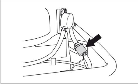
4. Установіть новий паливний фільтр на кінцях шлангів. Нанесіть рідкий миючий засіб на кінці паливного фільтра, щоб полегшити з'єднання.
