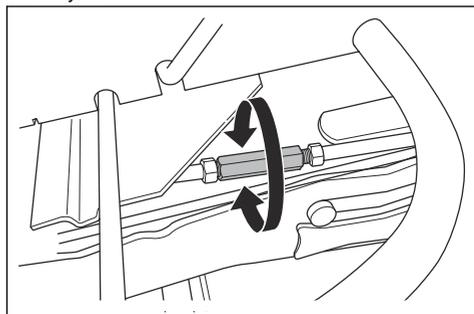
5. Затяните гайки на подъемной стойке после завершения регулировки.
