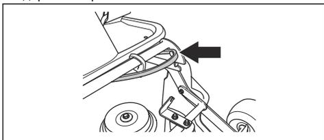
10. Установите деревянный брусок между рамой оборудования и шасси. Это позволит избежать отскакивания режущей деки при снятии.
