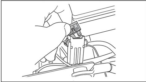
3. Замените перегоревший предохранитель предохранителем такого же типа, плоский штифт 15 А.
