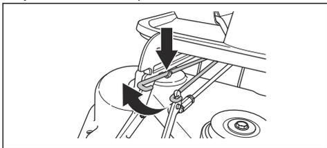
7. Потяните за ушко пружины, чтобы ослабить пружину натяжения приводного ремня.
