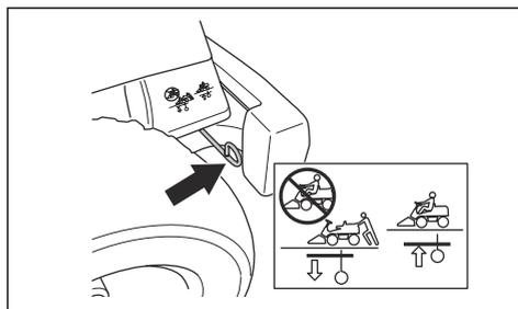
Рычаг системы привода для передней оси на модели Rider 216 AWD находится за левым передним колесом.
