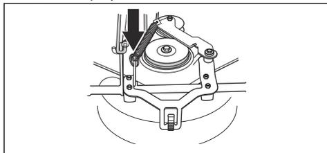
8. Поставете върха на пружината в държача върху рамото за опъване на задвижващия ремък.
