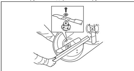
3. Ослабьте и снимите болт ножа, шайбы и нож.
