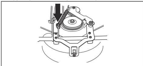
8. Поместите ушко пружины в держатель на рычаге регулировки натяжения приводного ремня.
