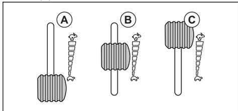
**Примечание:** Включение ножей, когда двигатель работает на полных оборотах, приводит к натяжению приводных ремней. Не открывайте дроссель полностью, пока режущая дека не будет опущена в рабочее положение.
