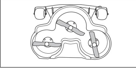
3. Затягніть болти леза з обертальним моментом затягування 45–50 Н·м.
