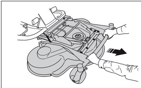
3. Поднимайте режущую деку в вертикальное положение, пока не услышите щелчок. Режущая дека автоматически фиксируется в вертикальном положении.
