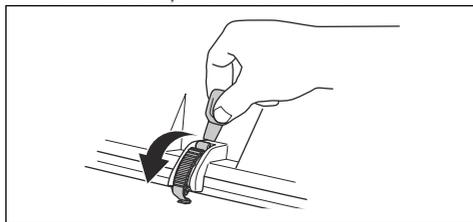
3. Plijați capota motorului în spate.
