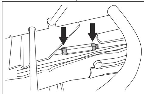
4. Въртете пръта за повдигане, за да удължите или скъсите опората. Удължете опората за повдигане на задния ръб на капака. Скъсете я, за да спуснете задния ръб на капака.
