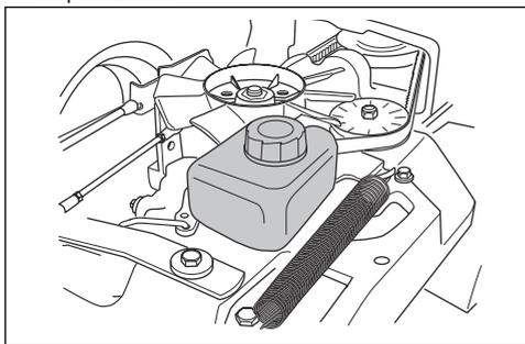
3. Adăugați ulei de motor dacă nivelul uleiului se află sub linia inferioară, însă nu depășiți linia superioară. Consultați *Date tehnice la pagina 125* pentru tipul de ulei recomandat.
