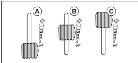
**Nota:** Cuplarea cuțitelor când motorul funcționează la viteză maximă solicită excesiv curelele de transmisie. Nu aplicați accelerația maximă înainte de a coborî capul tăietor în poziția de tuns iarba.
