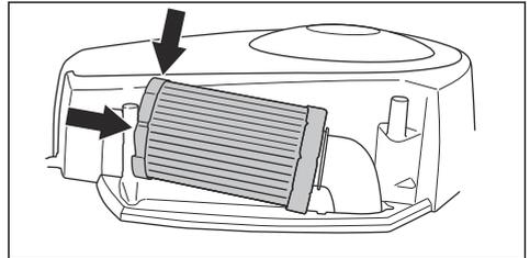
8. Встановіть кришку повітряного фільтра та затягніть фіксуючі голівки.
