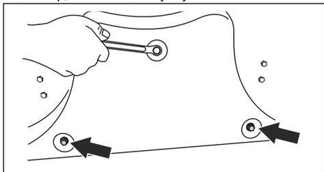
3. Заверните 3 винта M8x15 мм в резьбовые отверстия для заглушки BioClip, чтобы избежать повреждения резьбы.
