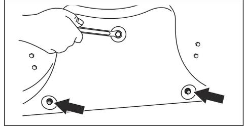
3. Установіть 3 гвинти M8 × 15 в отвори для гвинтів на заглушці BioClip для попередження пошкодження різбових поверхонь.
