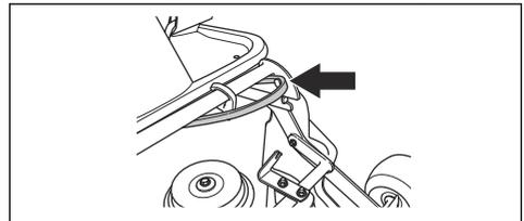
10. Установіть дерев'яний брусок між рамою обладнання й шасі. Це потрібно, щоб різальна дека не відскочила під час демонтажу.
