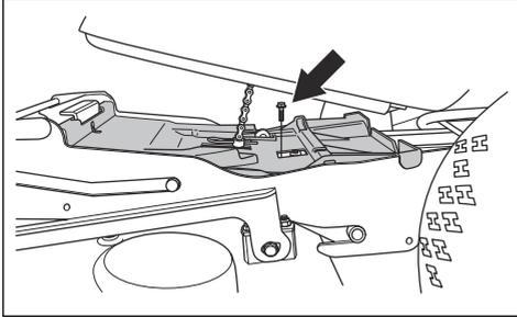
3. Відкрутіть гайки на підйомній розпірці.
