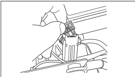
3. Замініть перегорілий запобіжник новим запобіжником такого ж типу, плавкий штир 15 А.
