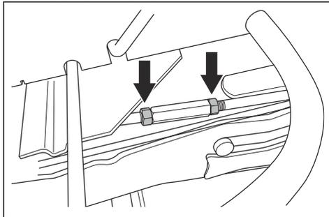
4. Rotiți tija pentru a extinde sau scurta opritorul. Extindeți opritorul pentru a ridica marginea posterioară a capucului. Scurtați opritorul pentru a coborî marginea posterioară a capucului.
