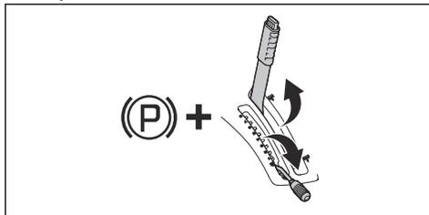
5. Разблокируйте шплинт на переднем кожухе с помощью инструмента, закрепленного на ключе зажигания, и снимите крышку.
