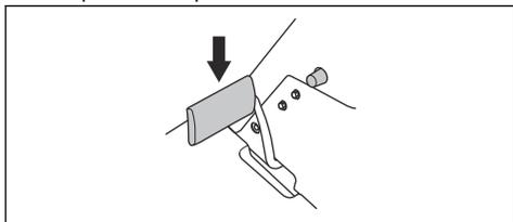
3. Apăsați cu atenție una dintre pedalele de accelerație. Cu cât apăsați mai mult pedala, cu atât viteza va fi mai mare. Utilizați pedala (1) pentru înaintare, iar pedala (2) – pentru marșarier.
