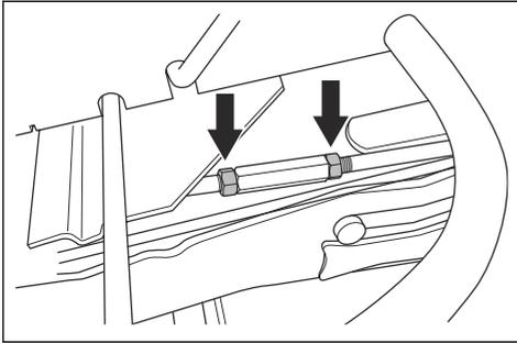
4. Поверніть підйомну розпірку таким чином, щоб подовжити або вкоротити опору. Витягніть опору, щоб підняти задню кромку кришки. Вкоротіть опору, щоб опустити задню кромку кришки.
