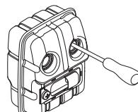
Compruebe regularmente que el silenciador esté firmemente montado en la máquina.
