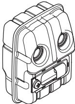
En países con clima cálido y seco, puede ser grande el riesgo de incendio. Por eso, hemos equipado a ciertos silenciadores con cortafuegos. Controle si el silenciador de su máquina lo tiene.
