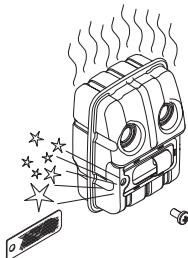
**¡NOTA!** No utilice nunca la máquina con un silenciador en mal estado.
