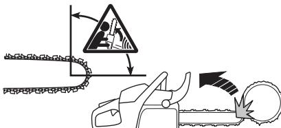
O retrocesso desloca-se sempre na direcção do plano da lâmina. Mais comum é que a moto-serra e a lâmina sejam arremessadas para cima e para trás, contra o utilizador. Entretanto, ocorrem outras direcções de retrocesso, dependendo da posição da moto-serra no momento em que o sector de risco de retrocesso a lâmina entrou em contacto com um objecto.
