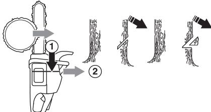
La profundidad del corte de indicación debe ser igual a 1/4 del diámetro del tronco, y el ángulo entre los cortes superior e inferior debe ser de 45° como mínimo.
