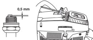
Observe! Use sempre o tipo de vela de ignição recomendado! Uma vela de ignição incorrecta pode danificar o pistão/cilindro. Verifique se a vela de ignição não produz interferências de rádio.
