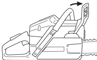
**Arranque:** O travão da corrente deve estar activado no arranque da moto-serra. Active o travão levando a protecção contra o retrocesso para a frente.
