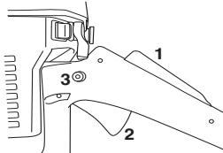
Se a máquina estiver equipada com uma válvula descompressora (A): Comprima a válvula para diminuir a pressão no cilindro, o que facilita o arranque da máquina. A válvula descompressora deve usar-se sempre no arranque. Quando a máquina arranca, a válvula retorna automaticamente à posição original.
