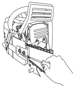
A corrente está correctamente esticada quando não mais estriver frouxa na parte inferior da lâmina e ainda possa ser girada facilmente com a mão. Aperte bem as porcas da lâmina com a chave universal ao mesmo tempo que segura a extremidade da lâmina.
