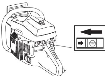
O motor pára ao desligar a ignição. (Desloque o contacto de paragem para a direita.)
