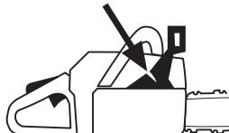
Mova a protecção anti-retrocesso para a frente e para trás, controlando assim se esta funciona a contento e
