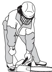
Segure no punho dianteiro com a mão esquerda. Ponha o pé direito na parte inferior do punho traseiro e pressione a moto-serra contra o solo. Agarre na pega do arranque e puxe devagar a corda de arranque com a mão direita até encontrar resistência (os prendedores do arranque actuam) e a partir de então dê puxões rápidos e fortes.
