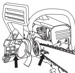
Tense la cadena enroscando en el sentido de las agujas del reloj el tornillo de tensado con la llave combinada. La cadena debe tensarse hasta que deje de colgar en la parte inferior de la espada.
