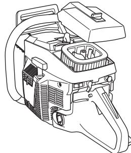
Uma limpeza mais completa obtém-se ao lavar o filtro com água e sabão.
