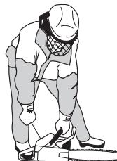
Agarre el mango delantero con la mano izquierda. Pise la parte inferior del mango trasero con el pie derecho y presione la motosierra contra el suelo. Agarre la empuñadura de arranque con la mano derecha y tire lentamente del cordón hasta que advierta una resistencia (agarran los ganchos de arranque). Luego, dé tiros rápidos y fuertes. **Nunca enrosque el cordón de arranque alrededor de la mano.**
