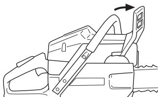
**Arranque:** El freno de cadena debe estar activado al poner en marcha la motosierra. Active el freno moviendo la protección contra reculadas hacia delante.
