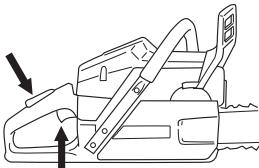
Dado que el freno de cadena todavía está activado, se deben bajar las revoluciones del motor lo antes posible a ralenti, y esto se logra desconectando rápidamente el fiador contra aceleraciones involuntarias. De ese modo, se evita un desgaste innecesario del embrague, del tambor del embrague y de la cinta de freno.
