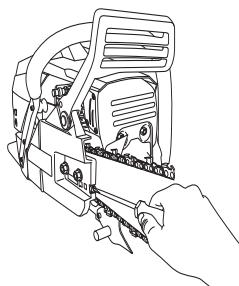
La cadena está correctamente tensada cuando no cuelga en la parte inferior de la espada y puede girarse fácilmente con la mano. Apriete las tuercas de la espada con la llave combinada, sujetando al mismo tiempo la punta de la espada.
