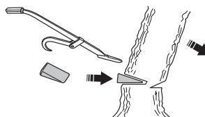
Recomendamos o uso de um comprimento de lámina superior ao diâmetro do tronco na copa da árvore, de modo que o corte de abate e o corte direccional possam ser executados com o chamado 'corte simples'. Ver o capítulo Especificações técnicas com relação ao
