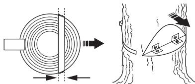
Perde-se todo o controlo sobre a direcção de queda da árvore se a linha de ruptura for demasiado pequena ou muito serrada, ou se o corte direccional e o corte de abate estiverem incorrectamente posicionados.
