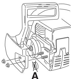
Monte a lâmina nos seus parafusos. Coloque a lâmina na sua posição mais atrás. Ponha a corrente sobre o pinhão e a ranhura da lâmina. Comece pela parte superior da lâmina.
