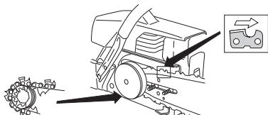
Verifique se o fio dos elos de corte está voltado para a frente, na parte superior da lâmina.
