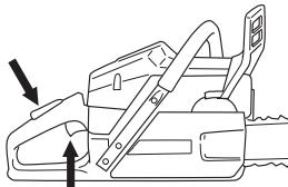
Uma vez que o travão da corrente continua activado, a rotação do motor deve ser baixada logo que possível para a marcha em vazio, o que se consegue desligando o bloqueio do acelerador. Deste modo pode evitar desgaste desnecessário da embraiagem, do tambor da embraiagem e das cintas de travagem.
