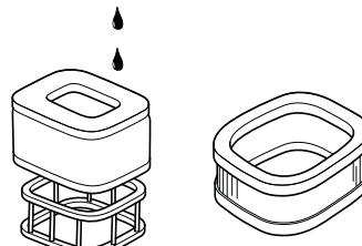
Um filtro de ar usado por longo tempo nunca pode ficar completamente limpo. Por isso o filtro deve, a intervalos regulares, ser trocado por um novo. **Um filtro danificado deve sempre ser substituído.**
