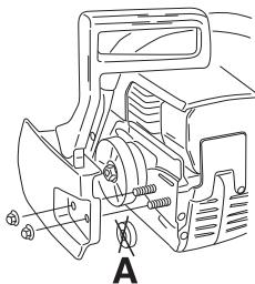
Monte la espada en los pernos. Sitúela en la posición posterior extrema. Monte la cadena en el piñón de arrastre y la guía de la espada. Empiece con la parte superior de la cadena.
