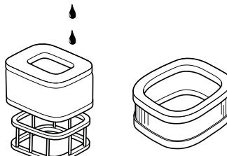
Un filtro utilizado durante mucho tiempo no puede limpiarse del todo. Por tanto, hay que cambiarlo a intervalos regulares. **Un filtro de aire averiado debe cambiarse.**
