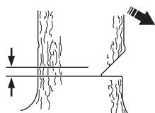
Coloque o apoio para casca (se estiver montado) atrás da linha de ruptura. Serre com aceleração total e deixe a corrente/lâmina penetrar devagar na árvore. Observe se a árvore se move no sentido contrário ao da direcção de queda pretendida. Introduza uma cunha de abate ou barra extractora logo que a profundidade de corte o permita.
