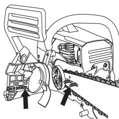
Estique a corrente, apertando com o auxílio da chave universal o parafuso esticador da corrente, no sentido horário. Estique a corrente até que esta deixe de estar frouxa na parte inferior da lâmina.
