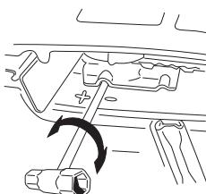
**¡ATENCIÓN! Al efectuar el ajuste, el motor no debe estar en marcha.**
