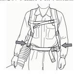
将臀带置于臀部上方,不要离腹部太远。 系紧臀带,以 便感觉到靠在臀部上的吹风机的重量。 系紧并调整胸带 以获得最佳工作位置。
