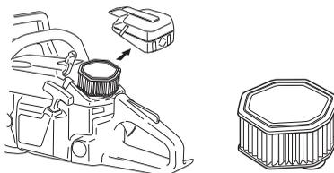
Uma limpeza mais completa obtém-se ao lavar o filtro com água e sabão.
