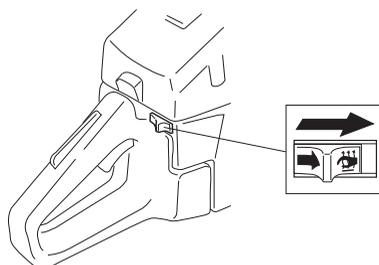
Si se empuja el interruptor hacia la derecha, se pone en funcionamiento la calefacción. Si se empuja hacia la izquierda, se apaga la calefacción.
