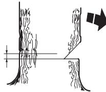
Coloque o apoio para casca (se estiver montado) atrás da linha de ruptura. Serre com aceleração total e deixa a corrente/lâmina penetrar devagar na árvore. Observe se a árvore se move no sentido contrário ao da direcção de queda pretendida. Introduza uma cunha de abate ou barra extractora logo que a profundidade de corte o permita.
