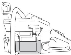
¡NOTA! Si se ha montado el conjunto especial de invierno o si se han tomado medidas para aumentar la temperatura, debe cambiarse al reglaje normal, puesto que la máquina funciona con temperatura normal. De lo contrario, hay riesgo de sobrecalentamiento con las consiguientes averías graves del motor.
