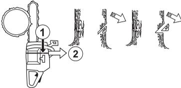
La profundidad del corte de indicación debe ser igual a  $1/4$  del diámetro del tronco, y el ángulo entre los cortes superior e inferior debe ser de  $45^\circ$  como mínimo.
