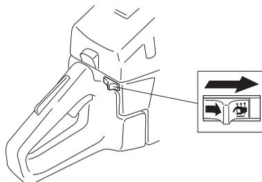
Ao premir o contacto para a direita, liga-se o aquecimento. Ao premir o contacto para a esquerda, desliga-se o aquecimento.
