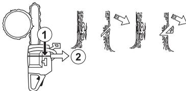
A profundidade do corte direccional deve ser de  $1/4$  do diâmetro do tronco e o ângulo entre o corte superior e o inferior, no mínimo de  $45^\circ$ .
