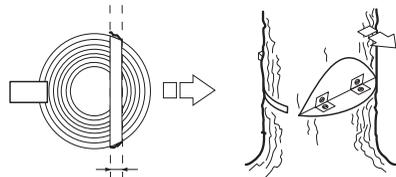
Perde-se todo o controlo sobre a direcção de queda da árvore se a linha de ruptura for demasiado pequena ou
