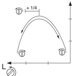
**¡NOTA!** Si la cadena gira en ralentí, debe girarse el tornillo T en sentido contrario a las agujas del reloj hasta que la cadena se detenga.
