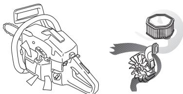
¡IMPORTANTE! Para que la depuración centrífuga funcione satisfactoriamente, debe efectuarse un mantenimiento constante del sistema. Limpie la toma de aire del mecanismo de arranque, las palas de ventilador del volante, el espacio alrededor del volante, el tubo de admisión y el compartimiento del carburador.
