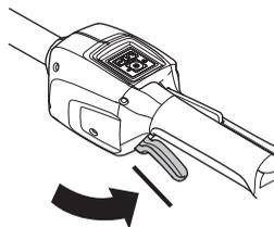
Pritisnite blokadu prekidača za uključivanje i provjerite vraća li se u prvobitni položaj nakon što je otpustite.
