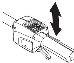
Provjerite kreću li se prekidač za uključivanje i blokada prekidača za uključivanje slobodno i funkcionira li povratna opruga ispravno.
