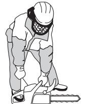
Segure a moto-serra numa posição firme, com os polegares e dedos à volta do punho.
