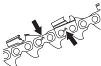
Para comprobar el desgaste de la cadena que utiliza, le recomendamos que la compare con una cadena nueva.
