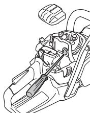
Para temperaturas abaixo dos -5°C e/ou condições de queda de neve, existe disponível uma cobertura especial que se monta na caixa do dispositivo de arranque.
