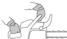
Acelere al máximo y active el freno de cadena girando la muñeca izquierda hacia la protección contra reculadas. No suelte el mango delantero. **La cadena debe detenerse inmediatamente.**
