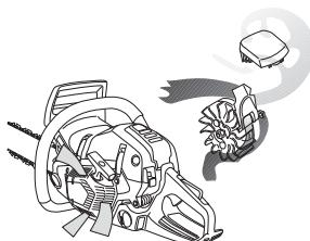
**¡IMPORTANTE!** Para que la depuración centrífuga funcione satisfactoriamente, debe efectuarse un mantenimiento constante del sistema. Limpie la toma de aire del mecanismo de arranque, las palas de ventilador del volante, el espacio alrededor del volante, el tubo de admisión y el compartimiento del carburador.
