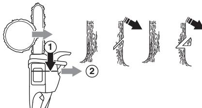
La profundidad del corte de indicación debe ser igual a  $1/4$  del diámetro del tronco, y el ángulo entre los cortes superior e inferior debe ser de  $45^{\circ}$  como mínimo.
