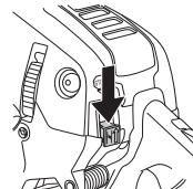
**¡ATENCIÓN!** El contacto de arranque/parada retorna automáticamente a la posición de marcha. Por consiguiente, para evitar el arranque involuntario hay que quitar siempre el capuchón de encendido de la bujía cuando se abandona la máquina.
