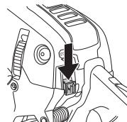
**NOTA!** O interruptor de Arranque/Paragem retorna automaticamente à posição de operação. Por isso, para impedir arranque acidental, deve-se sempre remover o cachimbo da vela de ignição quando a máquina não está sob vigilância.
