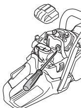
En el caso de temperaturas inferiores a -5 °C y/o con nieve, hay una cubierta especial que se coloca sobre el cuerpo del mecanismo de arranque.
