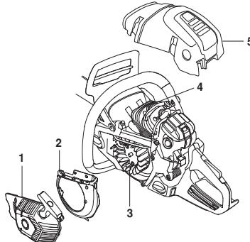
Limpie el sistema refrigerante con un cepillo una vez por semana (en condiciones difíciles, con mayor frecuencia). Un sistema refrigerante sucio u obturado produce sobrecalentamiento de la máquina, con las consiguientes averías del cilindro y el pistón.
