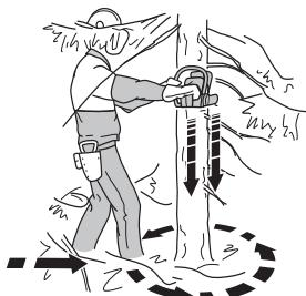
Remova a vegetação do solo em volta da árvore e prepare-se para eventuais obstáculos (pedras, galhos, buracos, etc.) de modo que possa fugir facilmente quando a árvore começar a cair. O caminho de fuga deve estar situada a cerca de  $135^{\circ}$  diagonalmente para trás da direcção de abate planeada para a árvore.
