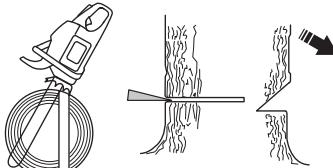
Повалящият срез трябва да завърши успоредно на линията на направляващия срез, като разстоянието помежду им трябва да бъде най-малко 1/10 от диаметъра на стъблото. Несвязаната част на дървото се нарича предпазна ивица.
