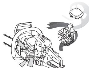
**ЗАПОМНЕТЕ!** За да действа центробежното почистване е необходимо да се провежда редовна поддръжка. Почиствете устройството за засмукване на въздуха в стартера, перките на вентилатора на маховика, пространството около маховика, входната тръбичка и пространството на карбуратора.
