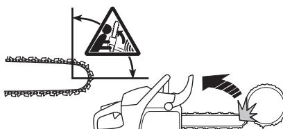
Обратният тласък е винаги в посока на шината. Обикновено верижният трион и шината се отхвърлят назад и нагоре, по посока на оператора. Но верижният трион може да отскочи и в други посоки в зависимост от
