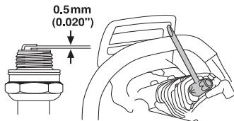
**ЗАБЕЛЕЖКА!** Използвайте винаги запалителните свещи от препоръчания вид! Използването на погрешен тип свещи може да предизвика сериозни повреди на буталото/цилиндъра. Убедете се, че запалителната свещ е снабдена със защита от радиосмущания.
