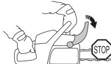
Фиксатор на дроселната клапа
