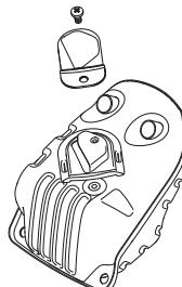
Ауспухът е предназначен за намаляване равнището на шума и насочване на отработените газове встрани от оператора. Отработените газове са нагрети и могат да съдържат искри, които да предизвикат пожар, когато попаднат върху сух и горлив материал.
