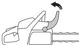
バーナットとクラッチカバー(チェーンブレーキ)を取り外します。輸送リング(A)も取り外します。
